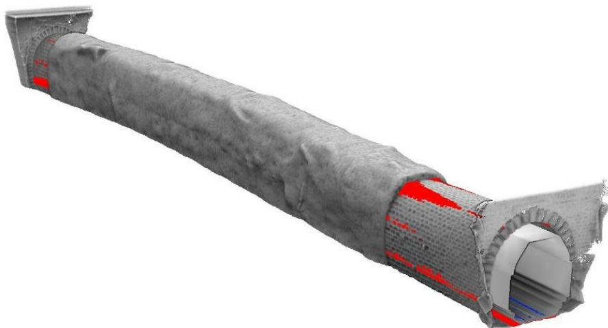
Obr. 7 Průkaz prostorové průchodnosti na 3D modelu (Žďárský tunel)
